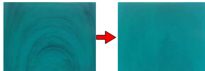
Fig. 3: Liniile de flux pot fi eliminate prin folosirea duzelor cu mixare
