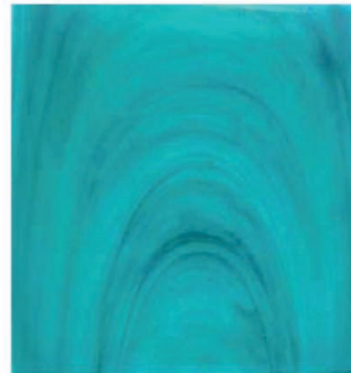
Linile de flux pot fi eliminate prin folosirea duzelor cu mixare
