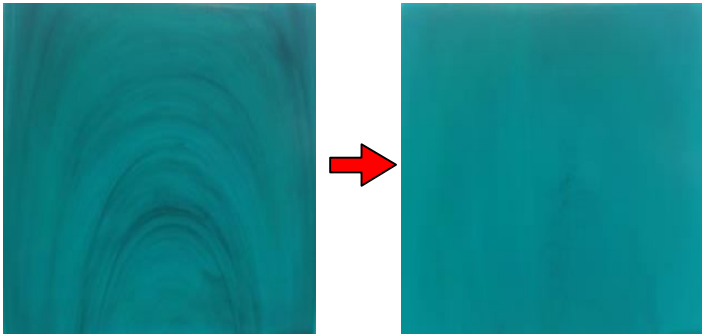
Fig. 3: Liniile de flux pot fi eliminate prin folosirea duzelor cu mixare
