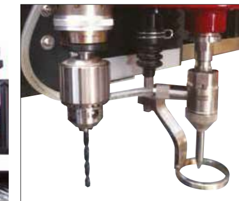
Pre-drilling cnc mechanical system Sistema di preforo meccanico o per bisellatura fori
