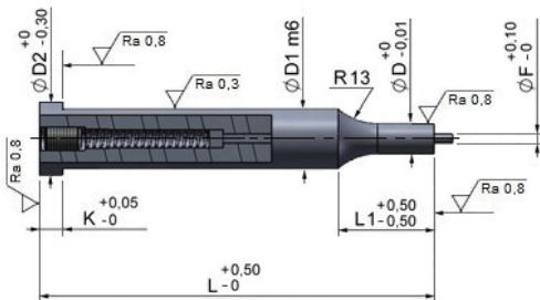
**Esecuzione:** Testa forgiata a caldo. Il gambo del punzone, dopo il trattamento termico ed il rinvenimento, viene finemente rettificato e lappato. La testa rettificata garantisce la perfetta coassialità con il gambo. Il ribasso è concentrico al gambo con una tolleranza massima di 0,01mm.
