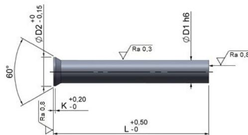
**Esecuzione:** Il gambo del punzone, dopo la ribattitura a caldo ed il rinvenimento, viene finemente rettificato e lappato. La stessa lavorazione di rettifica viene eseguita sulla testa conica. Le tolleranze di finitura, estremamente precise, rendono questi punzoni perfettamente intercambiabili.
