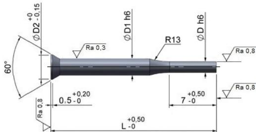
**Esecuzione:** Il gambo del punzone, dopo la ribattitura a caldo ed il rinvenimento, viene finemente rettificato e lappato. La stessa lavorazione di rettifica viene eseguita sulla testa conica. Le tolleranze di finitura, estremamente precise, rendono questi punzoni perfettamente intercambiabili. Il ribasso è concentrato al gambo con una tolleranza massima di 0,01mm.
